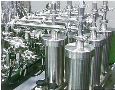
自動洗浄(CIP)対応のピストン装置
